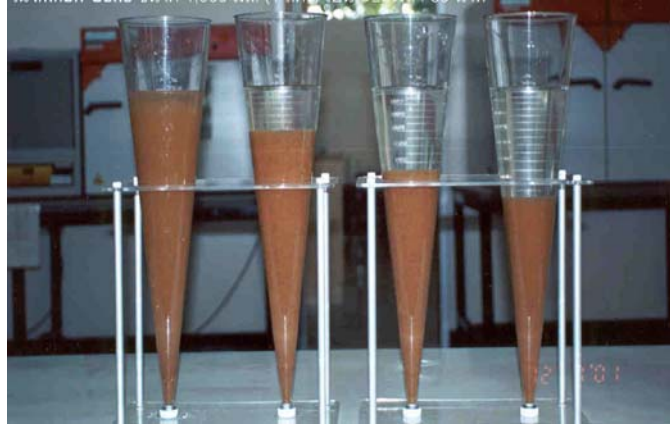
รูปที่ ๙ การประเมินลักษณะการตกตะกอนของ (SV 30 ) ระบบ เอ เอส (AS : Activated Sludge) ที่มา : http://infofile.pcd.go.th/mgt/590729-5.pdf?CFID=3027699&CFTOKEN=96188654
